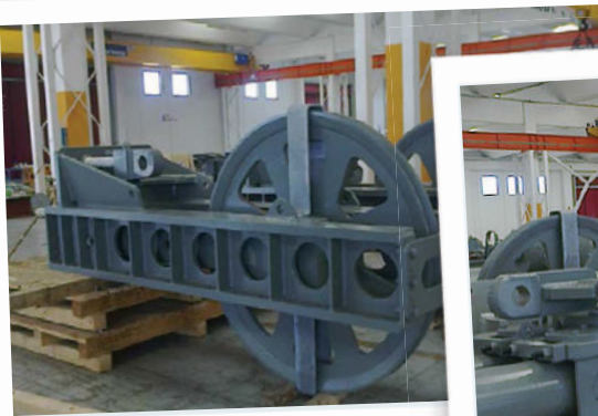
Poleas usadas para mover embarcaciones y compuertas
