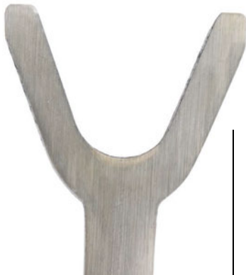
Fotografía sin retocar de una sección cortada de una polea McKissick endurecida con flama (en ácido 2-1/2 minutos) (NH4)2S408.
