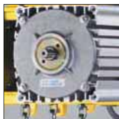
Embrague de deslizamiento regulable desde el exterior.
